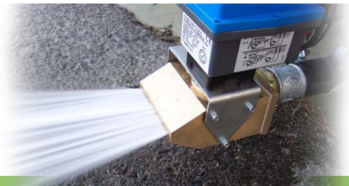
Instalación de baldeadores regulables con autómata programable en las baldeadoras.
