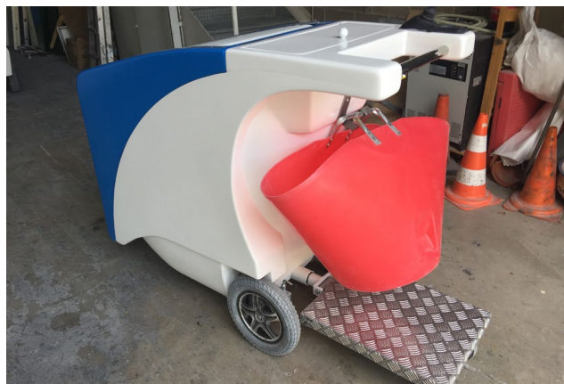
Carrito autopropulsado eléctrico con plataforma.
