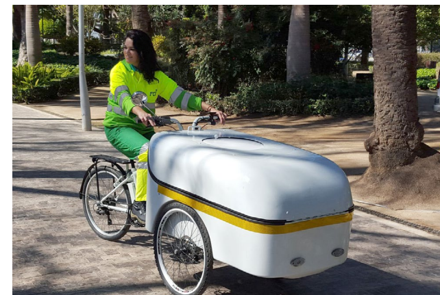
Triciclo de pedaleo asistido con motor eléctrico auxiliar PELUSA.
