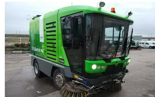
Prototipo de barredora eléctrica de 4/5 m 3 de capacidad.
