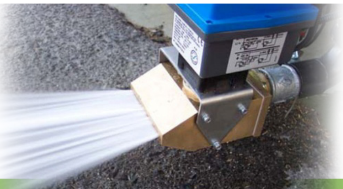
Instalación de baldeadores regulables con autómata programable en las baldeadoras.
