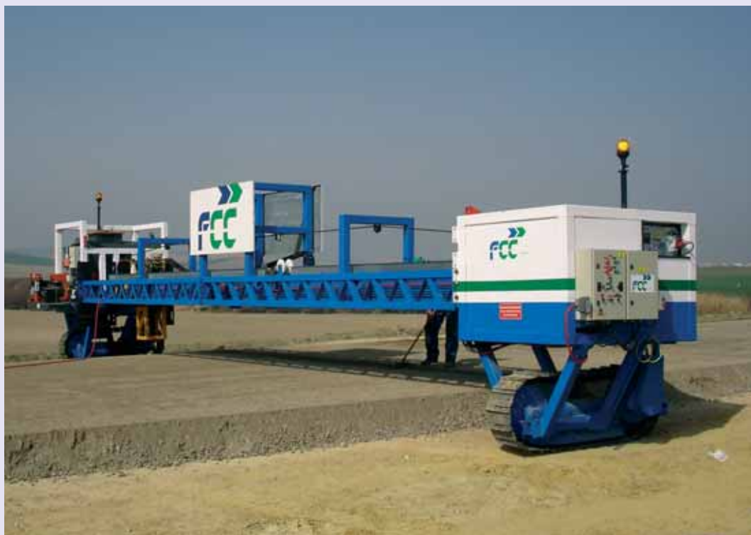
Carro prefisurador autopropulsado "Victoria"
